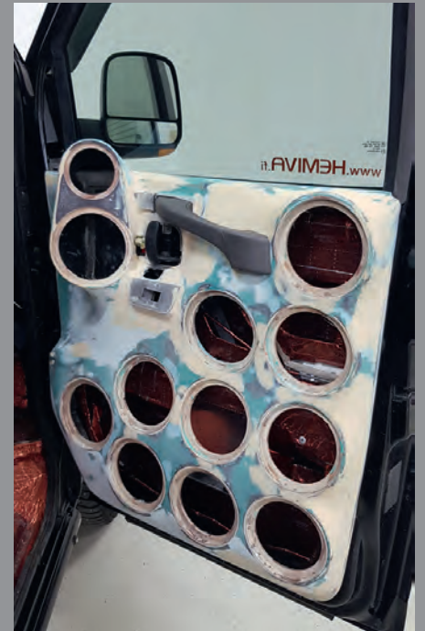
◀ Ovipahvit laminoitiin lasikuidulla edestä ja takaa neljällä kerroksella lasikuitumattoa.
