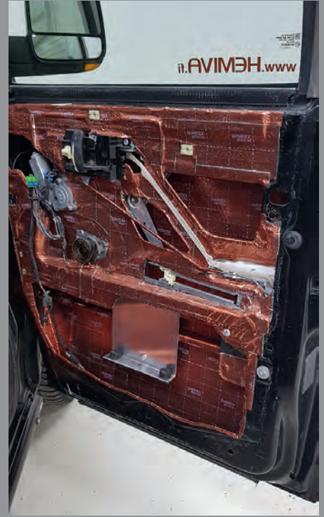
▲ Ovet vaimennettiin kerroksella butyyylimattoa.
