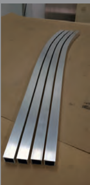
◀ Kaarelle mankeloidut profiiliputket seinien jäykisteitä varten.
