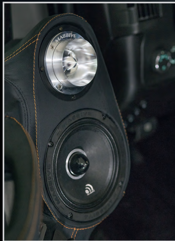
Diskantti ja keskari ovat nätissä laipassa suunnattuina. Tällä tavalla on mahdollista saada aikaan sopivan tarkka toisto ohjaamoonkin.
