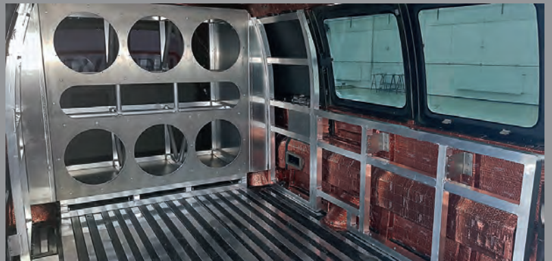
◀ Kaarelle mankeloidut profiiliputket seinien jäykisteitä varten.
