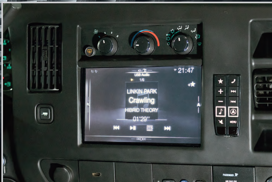
Alkuperäinen soitin sai väistyä Alpinen navisoittimen tieltä. Huomaa viereen asennetut käyttönappulat.
