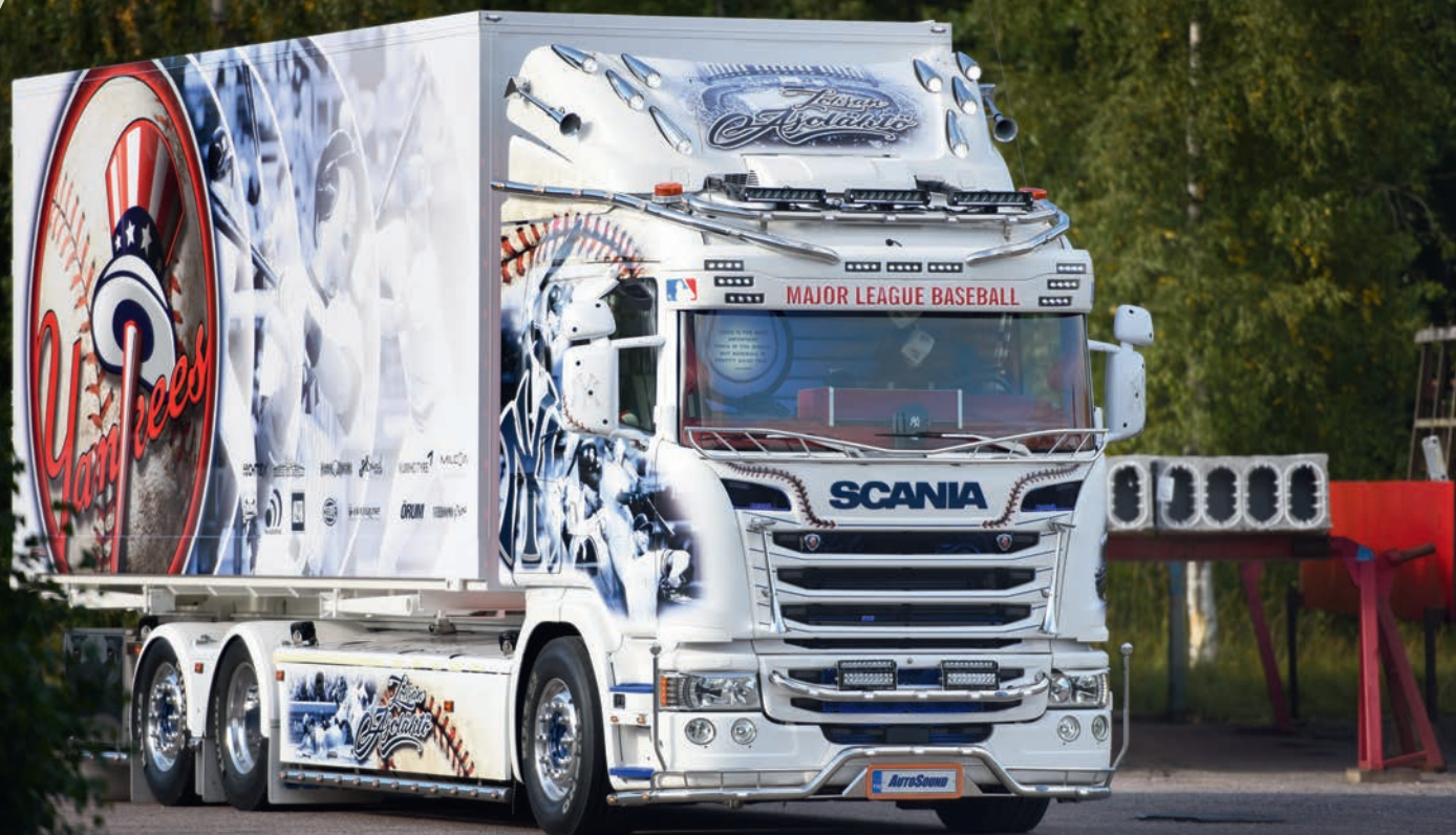
Auton grafiikat ovat Perttu Papusen käsialaa. Scania on kauttaaltaan teipattu, ja lisäksi teippipinnan päälle on vedetty kiiltävä lakkaus.
