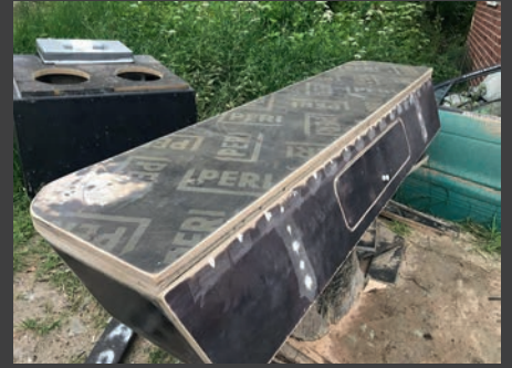
▲ Kotelo on valmistettu paksusta vanerista, jota on joissain kohdissa vähän useampikin kerros päällekkäin. Myös sisäistä tuentaa on käytetty.
