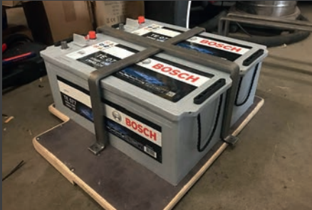
▲ Scanian oma virtajärjestelmä on luonnollisestikin 24V, mutta hifistettä varten sinne asennettiin erillinen 12-voltin järjestelmä. Valitut akkumallit olivat isoja sekä fyysisiltä mitoiltaan että Ampeeritunneiltaan, mutta mikäs siinä kun tällä kertaa tilaa piisaa.
