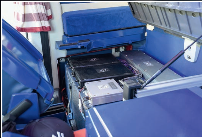
Parempi käsitys vahvistin ja virtapuolesta saadaan kun ohjaamon vuode käännetään ylös ja aletaan tutkia sen alapuolista elämää. Speksitaulukosta löytyy tarkemmat nippelitiedot.
