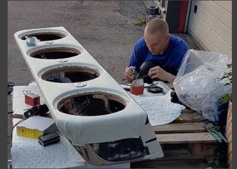
▲ Kotelo on valmistettu paksusta vanerista, jota on joissain kohdissa vähän useampikin kerros päällekkäin. Myös sisäistä tuentaa on käytetty.
