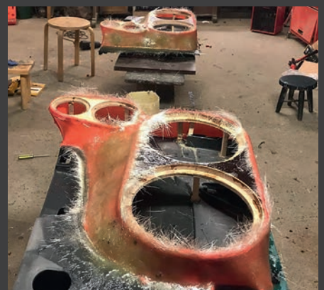
▲ Kun työauton oven aletaan asentaa tällaista elementtiarsenaalia, on syytä varmistaa huolella ennen hartsiämpärin avaamista että ne ylipäättään sopivat paikoilleen, että ovi menee kiinni kun kaiuttimet ovat paikoillaan ja kolmantena että kaiuttimet eivät häiritse ohjaamossa oleilua. Check, check, check. Homma jatkuu.
