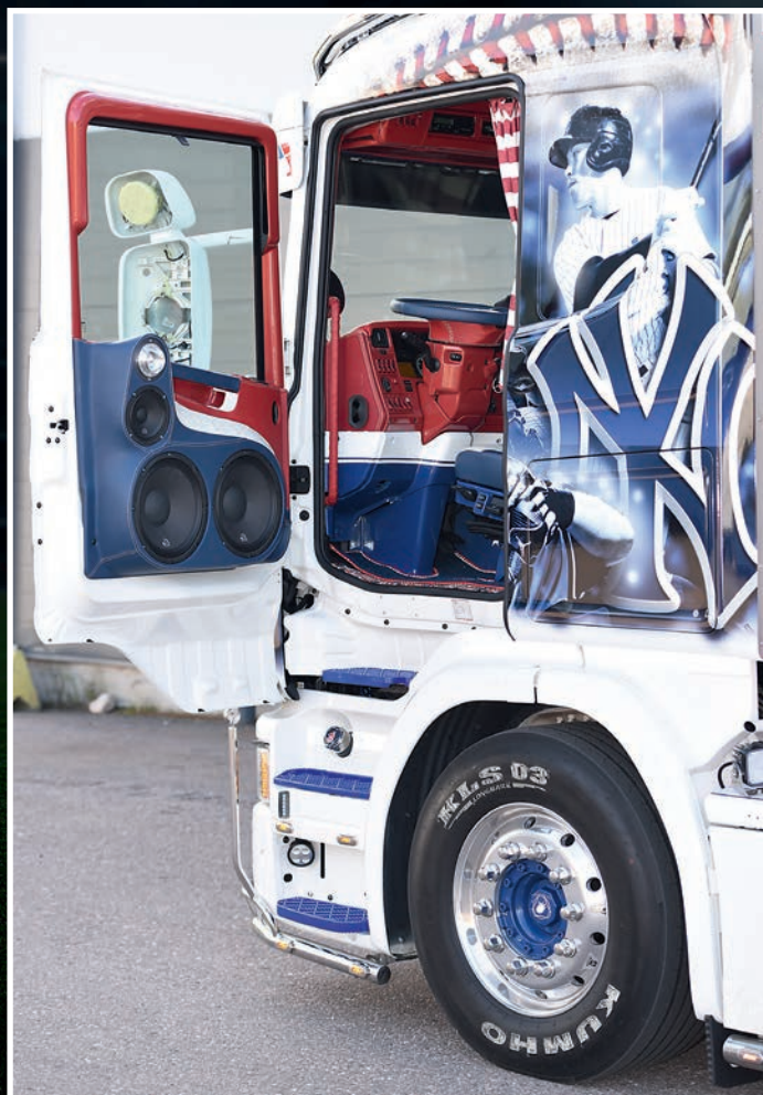
Scanian etuovien show-kaiuttimet sijaitsevat normaalimitaisen kuuntelijan pään korkeudella. Tällä on huomattavan suuri merkitys siihen miten kauas ja lujaa setti soi.
