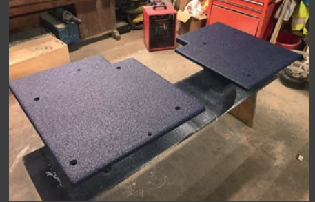
▲ Akkukoteloiden osia maalauksessa...
