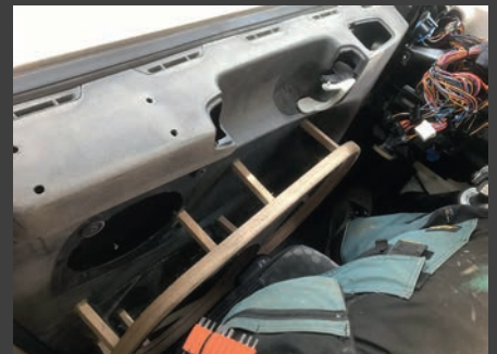
▲ Kun työauton oven aletaan asentaa tällaista elementtiarsenaalia, on syytä varmistaa huolella ennen hartsiämpärin avaamista että ne ylipäättään sopivat paikoilleen, että ovi menee kiinni kun kaiuttimet ovat paikoillaan ja kolmantena että kaiuttimet eivät häiritse ohjaamossa oleilua. Check, check, check. Homma jatkuu.
