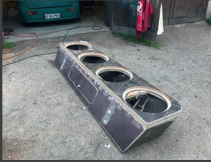
▲ Kotelo on valmistettu paksusta vanerista, jota on joissain kohdissa vähän useampikin kerros päällekkäin. Myös sisäistä tuentaa on käytetty.
