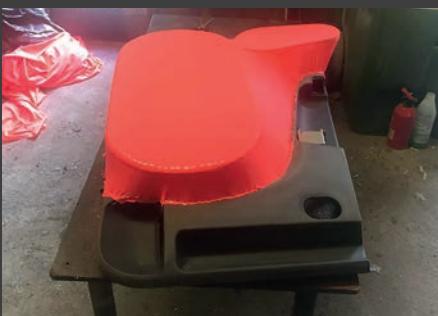
▲ Vanerikehikon päälle pingotettiin kangas, joka kostutellaan kauttaaltaan hartsiilla. Tällä muinaisella metodilla saadaan pohja sula-valinjaisille muodoille. Toisin kuin jotkut sitkeästi uskovat, sukka housut eivät ole tässä käytössä paras kangasvalinta. Paras kangas on sellainen, joka ei menetä muotoaan kastuttuaan, eli toisin sanoen se ei saa olla mahdollisimman venyvä.
