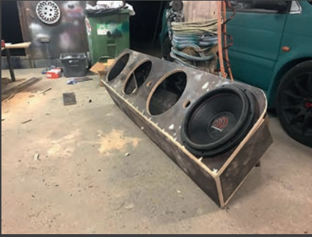
▲ Kotelon toimintaperiaate on suljettu ja siinä asustaa neljä 15" kokoista Massive Audion Summo-sarjan elementtiä.
