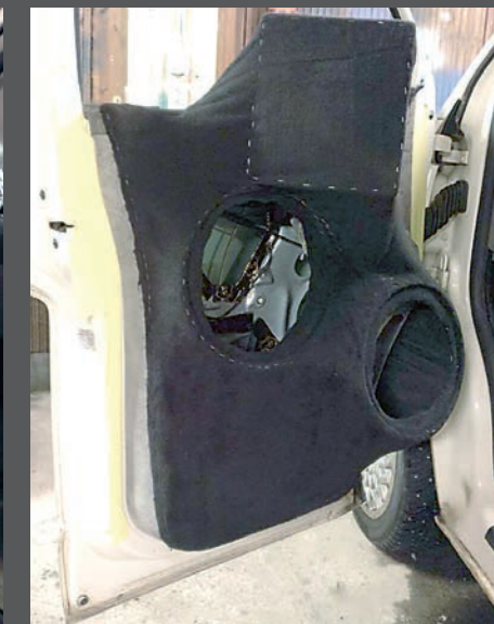
Sitten pingotettiin kangasta päälle... Ja siihen perään hartsia ja lasikuitua.
