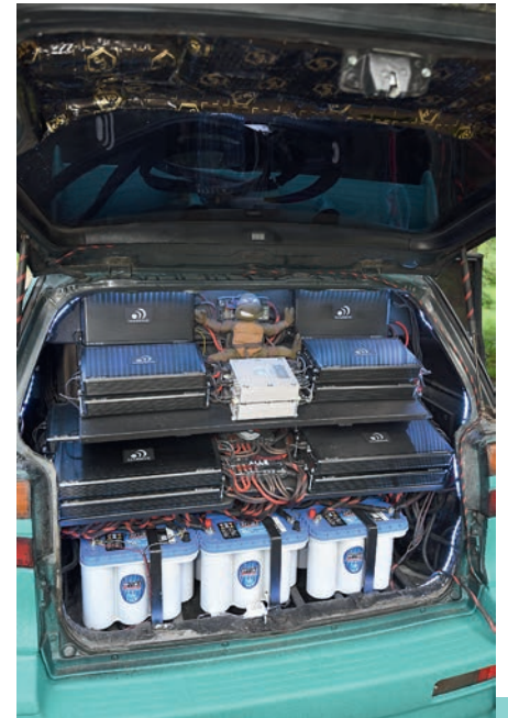
Etupään vahvistinkattaus ja signaaliprossut löytyvät auton perältä.
