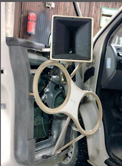
Tästä alkaa megajäreiden ovipaneelien valmistus. Ensiksi sahailtiin sopivat vanerikehykset elementeille.
