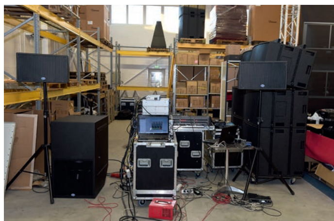
▲ Danleyn pienemmän pään kaiuttimet SH95 ja Danley TH-118 tapped-horn PA-subwoofer. Erityisesti TH-118 kuulosti vakuuttavalle jopa akustiikaltaan haastavassa varastotilassa. Toistoa kuvaavat hyvin sanat nopea ja dynaaminen. Tämän subbarin pikkuveli TH-Mini sai Mika Kuposelta ASTM:n erillistestissä täyden kympin. Oikeassa laidassa näkyvät kaksi miestä korkeampaa mustaa laatikkopinoa on Danleyn Exodus, kahdella eri suuntaavuuksilla synergysuorilla ja kahdella midbassatorvella toteutettu PA-kaiutinjärjestelmä. Toinen midi puuttuu kummastakin kassasta ja ne voi bongata taustalla olevasta hyllystä. Kuuleman mukaan noin 4000 hengen ulkoilmateknobleet hoituivat setillä ja reserviä jäi vielä käyttämättä.
