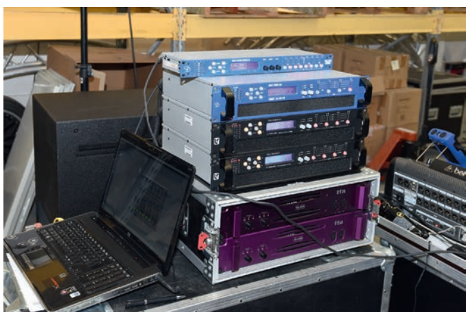
▲ Järjetön määrä tehoa ja prosessointikapasiteettia siistissä pinossa. Päällimmäisenä pinossa on Danleyn erillinen DSP tai paremminkin DSM DNA SC48. Se on käytössä alimpina pinossa oleville kahdelle FFA:n päätteelle. Toiseksi ylimmässä Danleyn DNA20K4PRO ja seuraavassa kahdessa Linea Researchin 44 series 20-päätteissä on DSP sisäänrakennettuna ja tehoa saadaan ulos maksimissaan 20 kW/kpl. Kerran kun pääsee käyttämään kunnollista PA-prossua, niin hetkessä tajuaa autokäyttöön tehtyjen DSP-laitteiden ominaisuuksien rajoituneisuuden. Kuinka moni on löytänyt omasta prossustaan esimerkiksi latenssinäytön, joka kertoo, paljonko kyseisen kanavan suodot ja ekvalisoinnit viivästävätkä kanavan signaalia?
