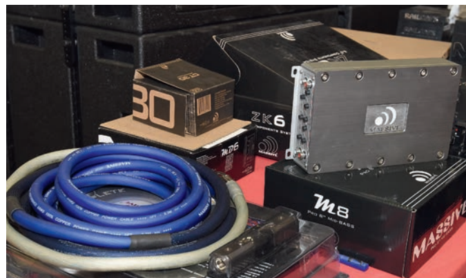
▲ DBX4-päätte antaa tehtaan tehoilmoituksen mukaan 4x250W kahden ohmin kuormaan, neljän ohmin kuormaan saadaan poikkeuksellisesti lähes sama teho. Päätteessä on moneen taipuvat suotimet. Käyttäjäkokeuksia Marko kertoo kertyneen Sepon Sprintteristä. Päätteen ääni on mukava eikä päätte lämpiä juurikaan edes sillattuna kaksikanavaisiksi. AKO 50 mm2:n virtakitti on varmasti laadultaan hyvä, mutta kallis. Päävirtakaapeli ja muut tilkkeet kääntävät vaa'n viisarin valmispakkaukselle kunnioitettavaan lukemaan 4,4 kg. Moni vastaava paketti painaa paljon vähemmän.
