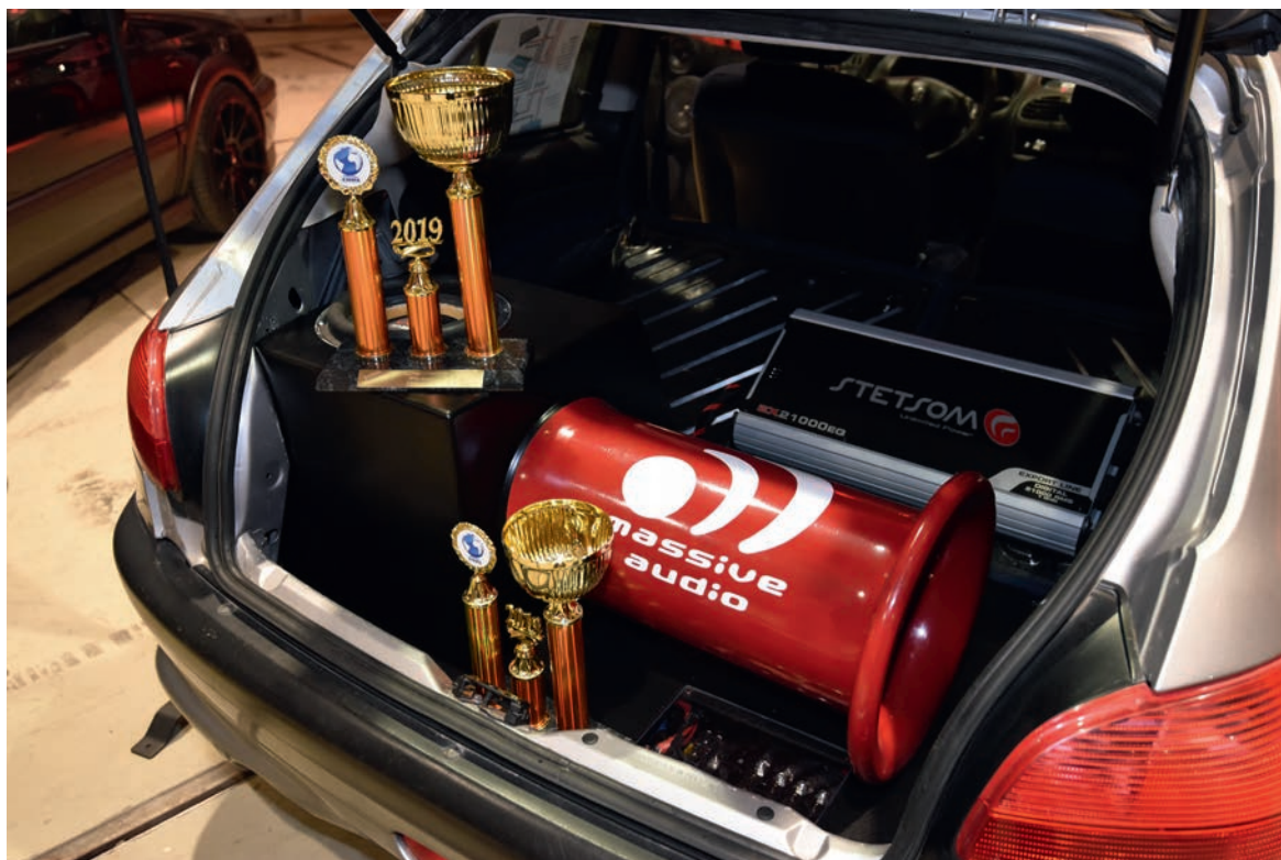
► Pösön finaalisetti herätti paljon keskustelua. Yksi kymppituumainen elementti refleksikotelossa jossa on kymppituumainen refleksiputki, ja koko hoitoa ohjaa vaatimattomasti 21-kilowattinen Stetsomin monsteripäite.
