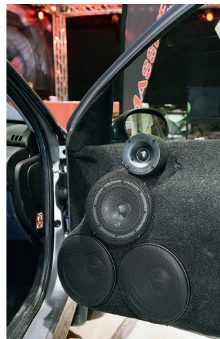
▲ Ovien elementtisijoittelusta voi päätellä ajatuksen olleen muun kuin puhtaasti ESQl:n. Ville oli suunnitellut siirtävänsä ainakin keskiääni- ja diskanttelementit ovien toiseen päähän. Pösö on niin pieni auto, että diskantit ja keskiäänet näkyvät ESQl-kuuntelupaikalle näinkin sijoitettuna.
